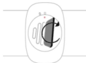
4. Use la herramienta para apretar la tapa de la batería en el sentido de las agujas del reloj.
